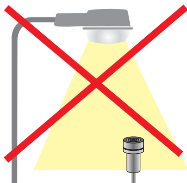
Rys. 10. Zakłócenia oświetleniem ulicznym Fig. 10. Interference by street lighting
